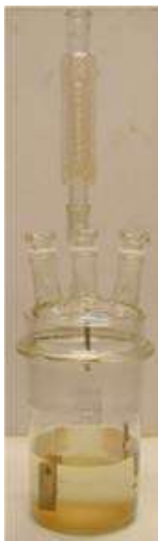
Figure 37.4.2.2 : Réacteur avec réfrigérant à reflux
