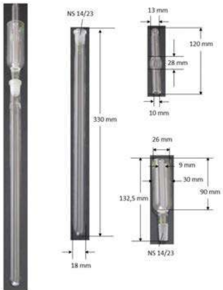
Figure A10.1 : Chambre de condensation pour l'épreuve de Bergmann-Junk (exemple 1)
