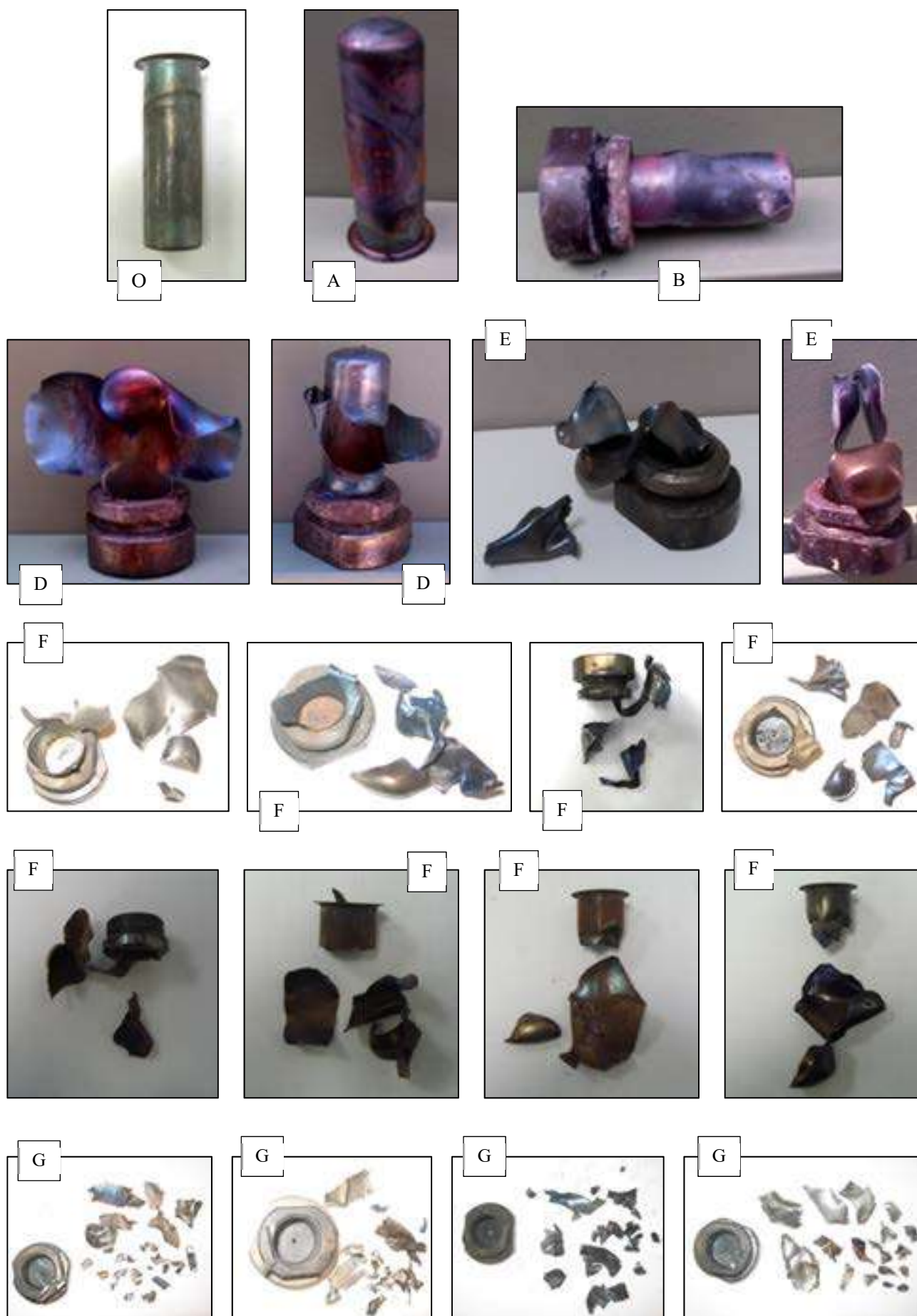
Figure 18.6.1.4 : Exemples de résultats de l'épreuve de Koenen
