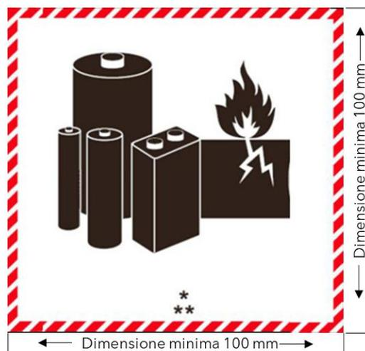
Se le dimensioni del collo lo richiedono, è possibile ridurre ulteriormente le dimensioni fino a 100 mm di larghezza x 70 mm di altezza.
